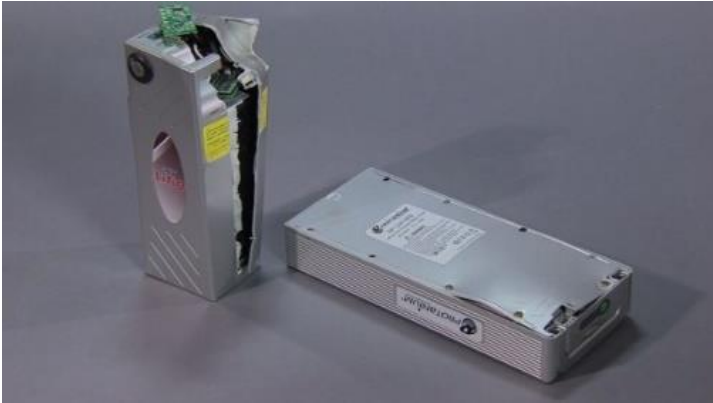
Abbildung 12: Beispiele für defekte Batterien mit Gefährdungspotential (aufgeplatzte Hülle, schnelle Zerlegung und Entzündung möglich)
