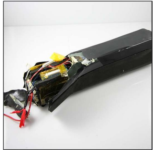
Abbildung 12: Beispiele für defekte Batterien mit Gefährdungspotential (aufgeplatzte Hülle, schnelle Zerlegung und Entzündung möglich)
