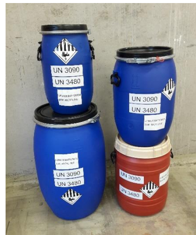
Abbildung 5: Verpackung inkl. Aufschrift und Gefahrzettel Muster 9A
