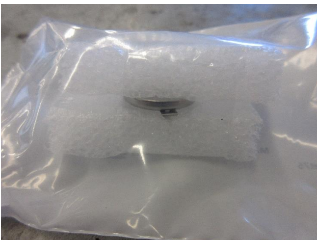
Abbildung 10: Verpackung für beschädigte Batterien kleiner 500g
