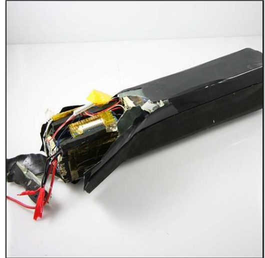
Abbildung 12: Beispiele für defekte Batterien mit Gefährdungspotential (aufgeplatzte Hülle, schnelle Zerlegung und Entzündung möglich)
