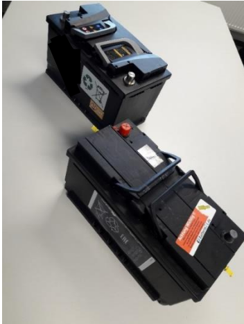
Abbildung 17: Starterbatterien (vorn im Bild Bleiakku, hinten im Bild Lithiumakku)
