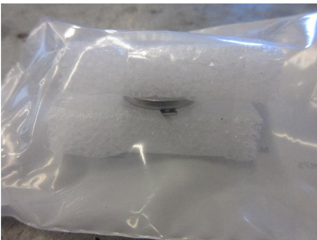
Abbildung 10: Verpackung für beschädigte Batterien kleiner 500g
