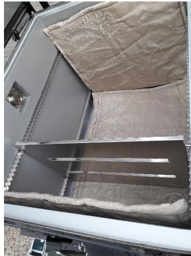
Abbildung 13: Beispiel für eine Transportverpackung defekter Batterien mit Gefährdungspotential
